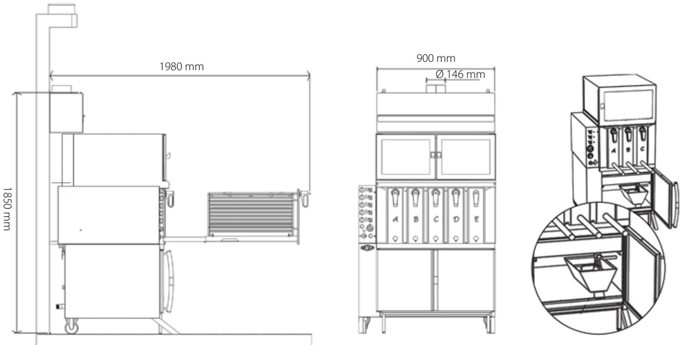
Un système d'écoulement constitué d'un conteneur de collecte d'eau à partir du tiroir récepteur à connecter à la boîte de graisses
